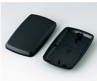
B9004856 Bottom and top part EM PMMA (IR) (UL 94 HB) black RAL 9005 68x42x18mm
