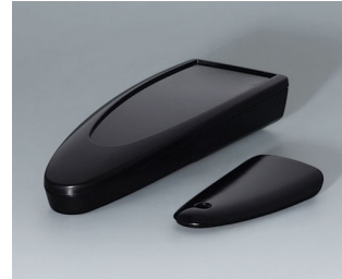
B2803016 STYLE-CASE M PMMA (IR) (UL 94 HB) black RAL 9005 147x56x27mm IP 65 opt., IP 40
