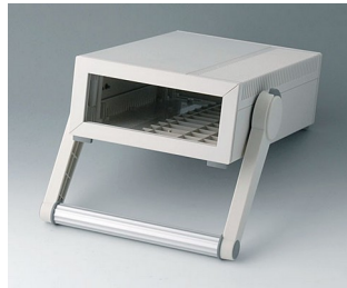
B2212107 MEDITEC E 220, avec poignée étrier ABS (UL 94 HB) gris blanc RAL 9002 160x260x74mm IP 40
