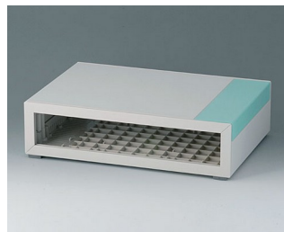
B2211015 MEDITEC D 160, sans poignée étrier ABS (UL 94 HB) gris blanc RAL 9002 290x200x74mm IP 40
