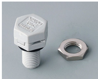
C2306917 Élément à compensation de pression M6x0,75 PA 6 (UL 94 HB) gris clair RAL 7035 IP 56
