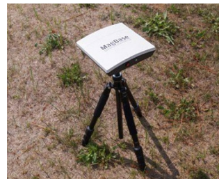
Station de mesure pour mesures stationnaires sur le terrain
