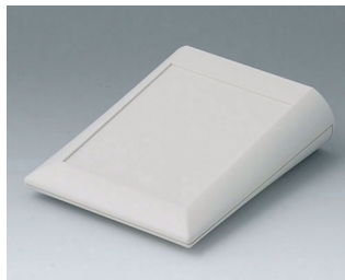
A0612007 COMTEC 120 F, Vers. I ABS (UL 94 HB) gris blanc RAL 9002 120x150x42,8mm IP 40
