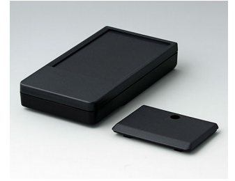
A9072219 DATEC-POCKET-BOX L PMMA (IR) (UL 94 HB) noir RAL 9005 120x65x22mm IP 54
