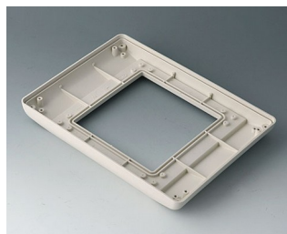
B4044717 Partie inférieure M plate, version II ABS (UL 94 HB) gris blanc RAL 9002 225x165x25,5mm IP 54 opt.
