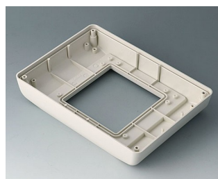
B4042757 Partie inférieure S surélevée, version I ABS (UL 94 HB) gris blanc RAL 9002 190x135x34,5mm IP 54 opt.
