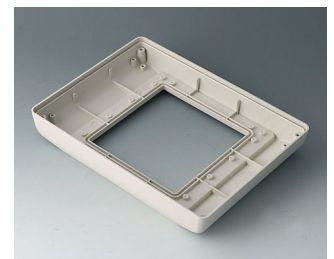
B4044767 Partie inférieure M surélevée, version II ABS (UL 94 HB) gris blanc RAL 9002 225x165x35,5mm IP 54 opt.
