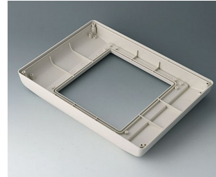
B4046757 Partie inférieure L surélevée, version I ABS (UL 94 HB) gris blanc RAL 9002 275x195x36,5mm IP 54 opt.
