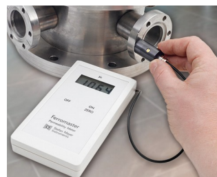
Ferromaster, l'instrument de mesure de la perméabilité
