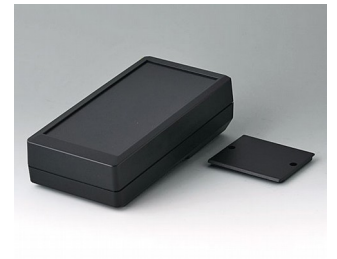
A9074129 DATEC-MOBIL-BOX M, Vers. I, surélévé ABS (UL 94 HB) noir RAL 9005 195x101x59mm IP 65 opt.
