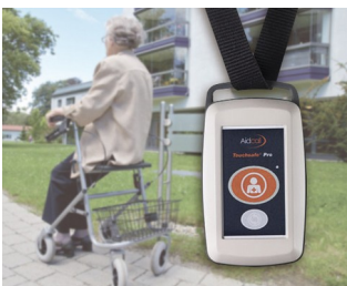
Émetteur radio pour système d'appel d'urgence patient
