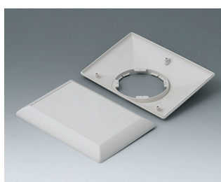
B5017207 Partie inférieure et supérieure E160 F ABS (UL 94 HB) gris blanc RAL 9002 160x110x38mm
