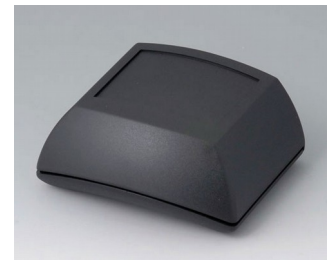
B7005109 ERGO-CASE S, surélevée ABS (UL 94 HB) noir RAL 9005 80x96x44mm IP 54 opt.
