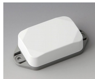
B1822226 MINI-DATA-BOX EF40, haute avec bride ASA+PC (UL 94 V-0) blanc signalisation RAL 9016 60x40x20mm IP 65 opt., IP 40
