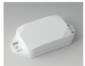
B1822127 MINI-DATA-BOX EF40, plate avec bride ASA+PC (UL 94 V-0) blanc signalisation RAL 9016 60x40x15mm IP 65 opt., IP 40
