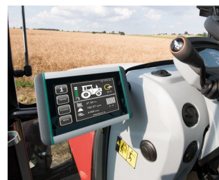
Terminal ISOBUS pour tracteurs et machines automotrices
