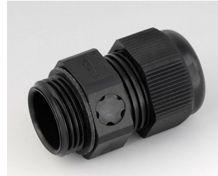
C2320919 Passe-câble à vis M20x1,5, compensation de pression PA noir RAL 9005 IP 68
