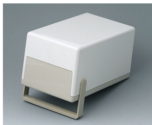
A9041165 BOITIER PLAT 189 H, Vers. II ABS (UL 94 HB) gris blanc RAL 9002 189x110x97mm IP 40
