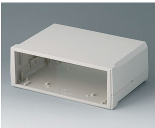
B3023127 MOTEC L, plate/surélévée ABS (UL 94 HB) gris blanc RAL 9002 235x165x85mm IP 40
