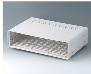
A0226170 EURO-BOITIER 63 T, sans poignée étrier ABS (UL 94 HB) gris blanc RAL 9002 367x250x98,5mm
