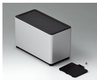
EE169059 SYNERGY E160 Aluminium AlMgSi 0,5 anodisé mat 160x80x100mm IP 40
