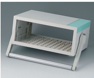
B2211305 MEDITEC D 160, mit Griffbügel ABS (UL 94 HB) grauweiß RAL 9002 290x200x124mm IP 40
