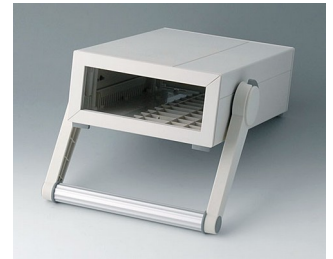
B2212117 MEDITEC E 220, mit Griffbügel ABS (UL 94 HB) grauweiß RAL 9002 160x260x74mm IP 40
