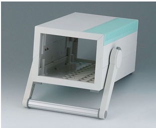
B2212305 MEDITEC E 220, mit Griffbügel ABS (UL 94 HB) grauweiß RAL 9002 160x260x124mm IP 40
