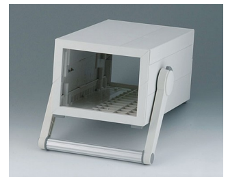
B2212317 MEDITEC E 220, mit Griffbügel ABS (UL 94 HB) grauweiß RAL 9002 160x260x124mm IP 40
