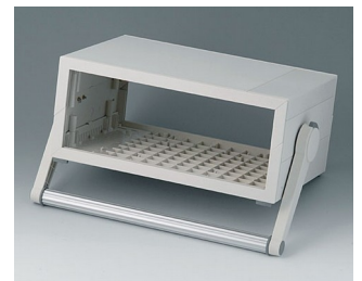
B2211317 MEDITEC D 160, mit Griffbügel ABS (UL 94 HB) grauweiß RAL 9002 290x200x124mm IP 40
