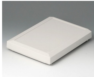
B4016617 Haube M, flach ABS (UL 94 HB) grauweiß RAL 9002 168x220x29mm
