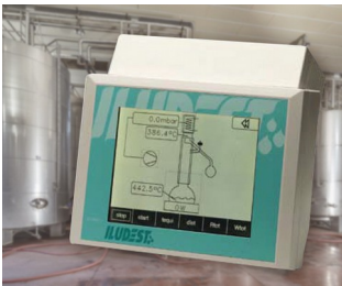
Gerät zur Überwachung und Steuerung von Destillationseinheiten
