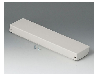
B4030417 Deckel L geschlossen, flach ABS (UL 94 HB) grauweiß RAL 9002 268x62x24mm
