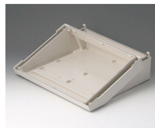
B4030217 DATEC-TERMINAL L, Ausf. II ABS (UL 94 HB) grauweiß RAL 9002 302x272x101mm IP 54 opt.
