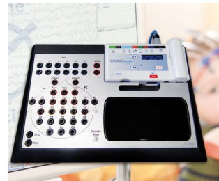
Stationäres System für Langzeit-EEG-Aufzeichnungen
