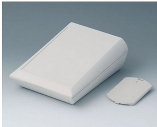
A0615117 COMTEC 150 H, Ausf. II ABS (UL 94 HB) grauweiß RAL 9002 150x200x71,5mm IP 40
