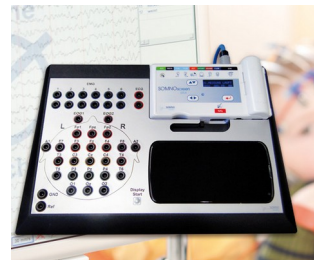
Stationäres System für Langzeit-EEG-Aufzeichnungen
