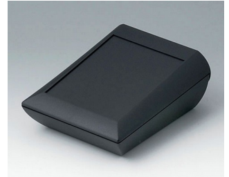
A0612109 COMTEC 120 H, Ausf. I ABS (UL 94 HB) schwarz RAL 9005 120x150x62,8mm IP 40
