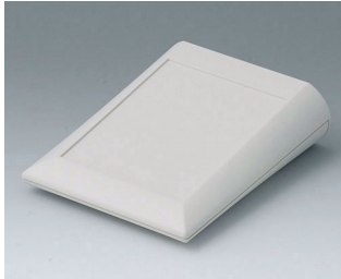
A0612007 COMTEC 120 F, Ausf. I ABS (UL 94 HB) grauweiß RAL 9002 120x150x42,8mm IP 40
