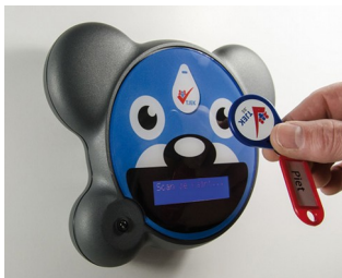
Zugangssteuerung für Kindergärten
