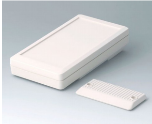
A9073107 DATEC-MOBIL-BOX S, Ausf. I ABS (UL 94 HB) grauweiß RAL 9002 152x83x33,5mm IP 65 opt.
