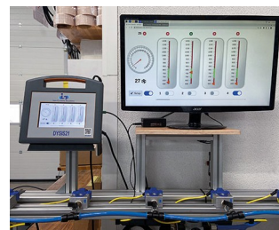
Überwachungssystem für Reinigungsdüsen
