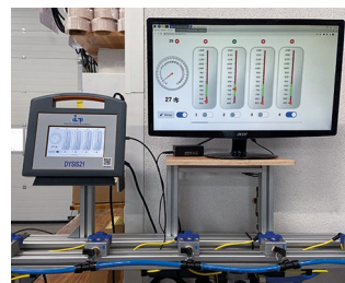
Überwachungssystem für Reinigungsdüsen
