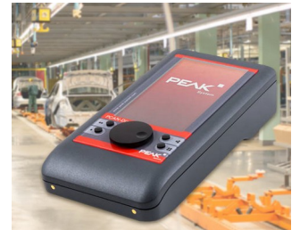
Mobiles Diagnosegerät für CAN- und CAN-FD-Busse
