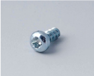
A0305031 Selbstformende Schraube 2,5 x 6 mm (PZ1)
