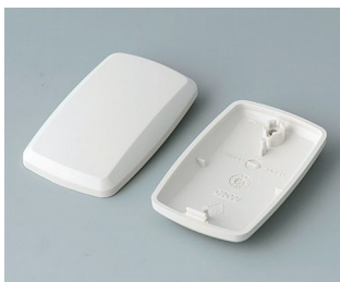
B9002857 Unter- und Oberteil ES ABS (UL 94 HB) grauweiß RAL 9002 52x32x15mm
