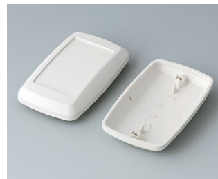
B9006817 Unter- und Oberteil EL ABS (UL 94 HB) grauweiß RAL 9002 78x48x24mm
