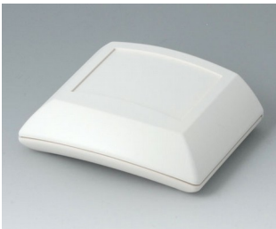
B7000107 ERGO-CASE S, flach ABS (UL 94 HB) grauweiß RAL 9002 80x96x32mm IP 54 opt.
