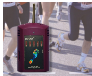
Dynamische Druckmessung zwischen Fuß und Schuh
