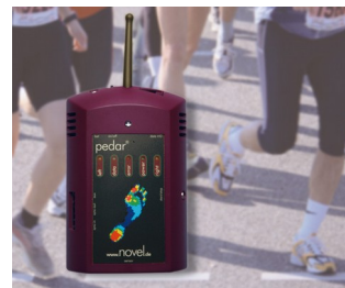
Dynamische Druckmessung zwischen Fuß und Schuh
