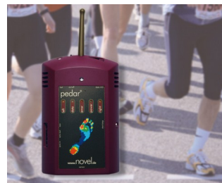
Dynamische Druckmessung zwischen Fuß und Schuh
