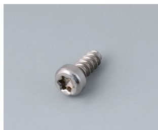
A0325060 Selbstformende Schraube 2,5 x 6 mm (T8) Edelstahl
