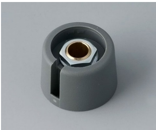
A3023638 COM-KNOBS 23, mit Aussparung PA 6 vulkan 23x16mm 1/4"
