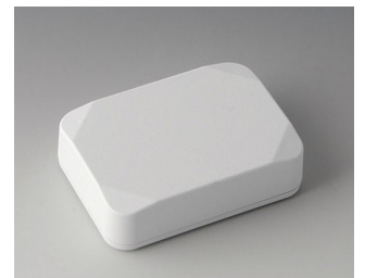
B1824217 MINI-DATA-BOX E50, hoch ASA+PC (UL 94 V-0) verkehrsweiß RAL 9016 70x50x20mm IP 65 opt., IP 40
