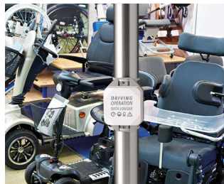
Datenlogger für den Fahrbetrieb
