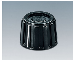
A1319260 DREHKNOPF, mit seitl. Schraubbefestigung PF (UL 94 V-0) schwarz RAL 9005 18,9x13,5mm 6mm
