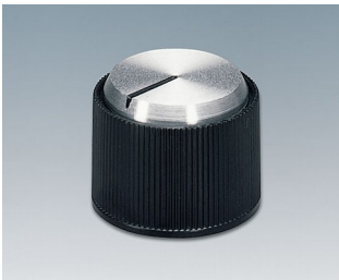
A1318260 DREHKNOPF, mit seitl. Schraubbefestigung ABS (UL 94 HB) schwarz/Alu 18,2x14,2mm 6mm
