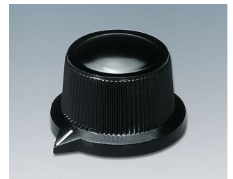
A1319560 DREHKNOPF, mit seidl. Schraubbefestigung PF (UL 94 V-0) schwarz RAL 9005 29x20,1mm 6mm
