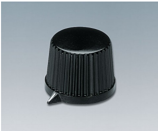
A1313560 DREHKNOPF, mit seidl. Schraubbefestigung PF (UL 94 V-0) schwarz RAL 9005 20x15,4mm 6mm
