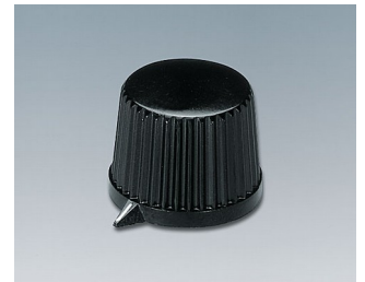
A1313540 DREHKNOPF, mit seitl. Schraubbefestigung PF (UL 94 V-0) schwarz RAL 9005 20x15,4mm 4mm
