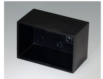
A8045250 MODUL-LEERGEHÄUSE, Ausf. | PF (UL 94 V-0) schwarz RAL 9005 45,1x30x24,9mm
