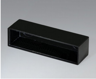
A8050150 MODUL-LEERGEHÄUSE, Ausf. | PF (UL 94 V-0) schwarz RAL 9005 49,9x13,1x15mm
