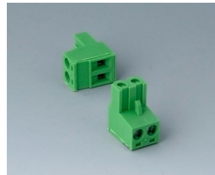
B6606223 Stiftleiste, Raster 5,08 PA 6 (UL 94 V-0)
