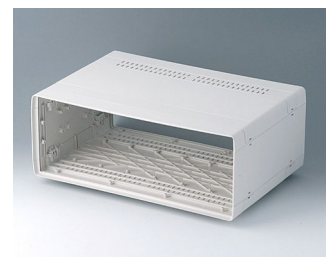
A0236170 EUROPA-GEHÄUSE 63 TE, o. Griffb. ABS (UL 94 HB) grauweiß RAL 9002 367x250x143mm
