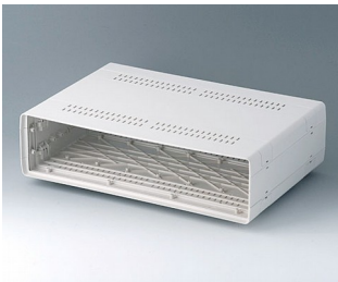
A0226270 EUROPA-GEHÄUSE 63 TE, o. Griffb. ABS (UL 94 HB) grauweiß RAL 9002 367x250x98,5mm
