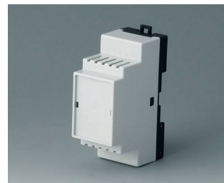
B6501116 RAILTEC B, 2 Module, Ausf. III PC (UL 94 V-0) lichtgrau RAL 7035 35x86x58mm
