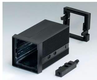
B6012021 NORM-EINBAUGEHÄUSE TYP A PPO (UL 94 V-0) schwarz RAL 9005 48x48x75mm
