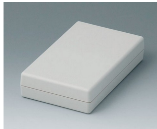
A9408331 SCHALENGEHÄUSE G 155, Ausf. I ABS (UL 94 HB) grauweiß RAL 9002 95x158x33mm IP 65 opt.
