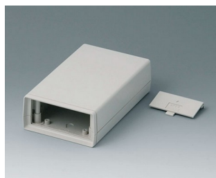
A9408346 SCHALENGEHÄUSE V 155, Ausf. IV ABS (UL 94 HB) grauweiß RAL 9002 95x158x45mm
