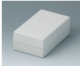
A9408441 SCHALENGEHÄUSE G 155, Ausf. I ABS (UL 94 HB) grauweiß RAL 9002 95x158x57mm IP 65 opt.
