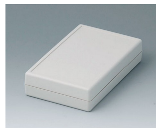
A9408351 SCHALENGEHÄUSE G 155, Ausf. I ABS (UL 94 HB) grauweiß RAL 9002 95x158x33,5mm IP 65 opt.
