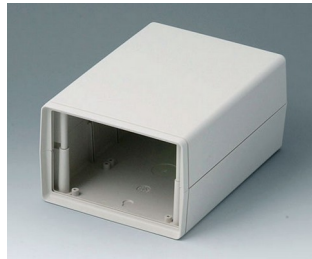
A9413443 SCHALENGEHÄUSE V 190, Ausf. I ABS (UL 94 HB) grauweiß RAL 9002 138x190x91mm
