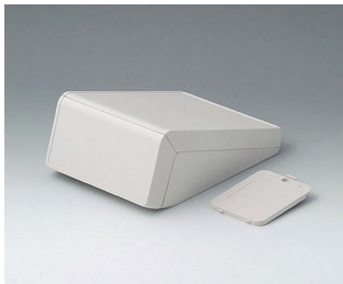
B4054207 UNITEC S, 0,6/0,6 ABS (UL 94 HB) grauweiß RAL 9002 125x177x69mm IP 40
